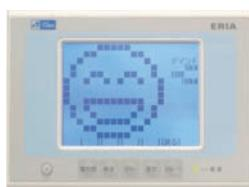
目標デマンド値を超過すると【注意】【警戒】表示などで、節電のタイミングをお知らせする専用モニターです。使用電力量をCO<sub>2</sub>換算して表示することも可能ですので、環境保護への貢献度を目で確かめながら節電活動に取り組めます。
